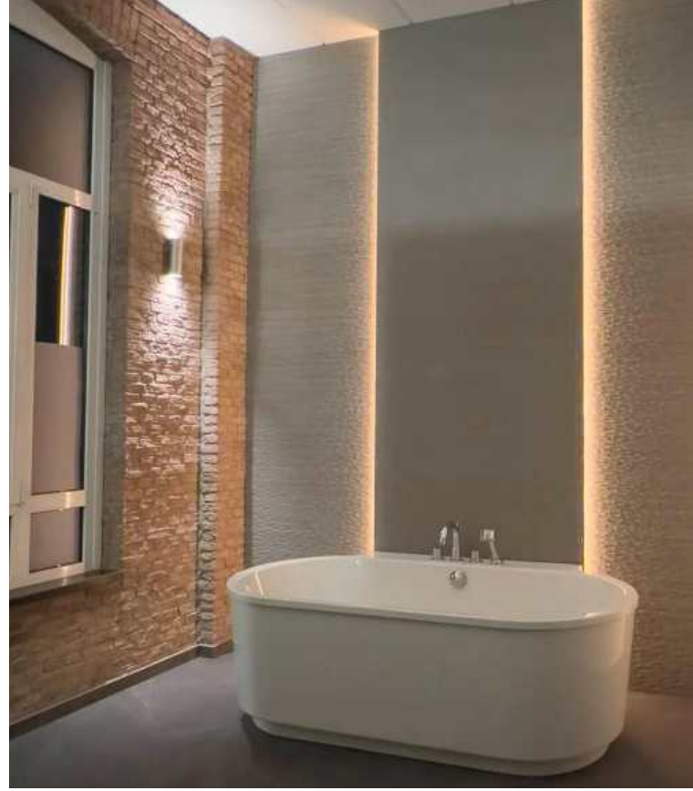
In vochtige omgevingen, zoals een badkamer, is het het best om spatwaterdichte strips met IP65 te gebruiken (Govaerts Elektro)
